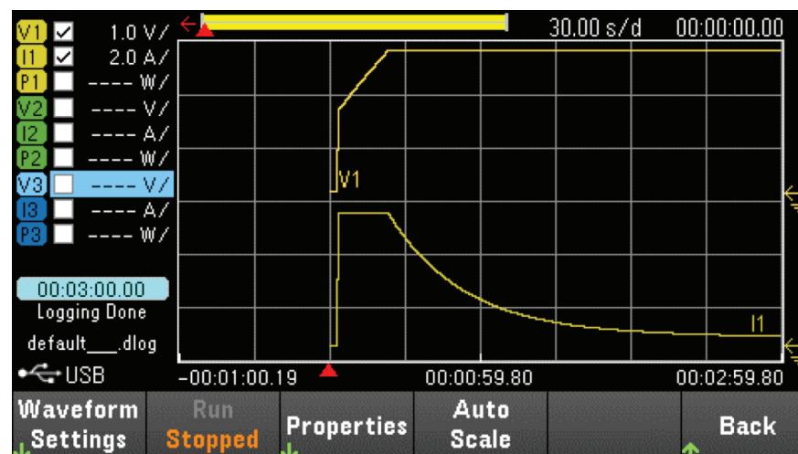
圖 2：Keysight E36312A 擷取 100 F 超級電容器的充電資料
