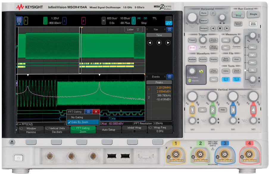
圖 8：在 Keysight InfiniiVision 示波器上執行頻譜分析
